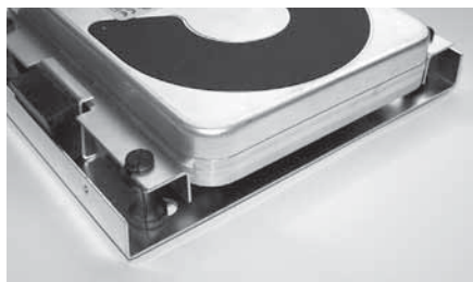
Obr. 5 - Pružné uchycení HDD
