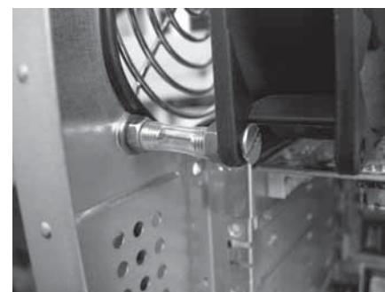
Obr. 3 - Pružné chycení větráku pomocí tenké hadičky
