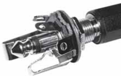
Obr. 5 - Zapnutí napájení fuzzu zasunutím konektoru od kytary
