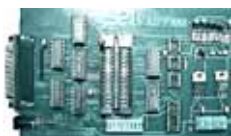
Obr. 1 - Eprom programátor Willeprom – osadená a funkčná doska plošných spojov
