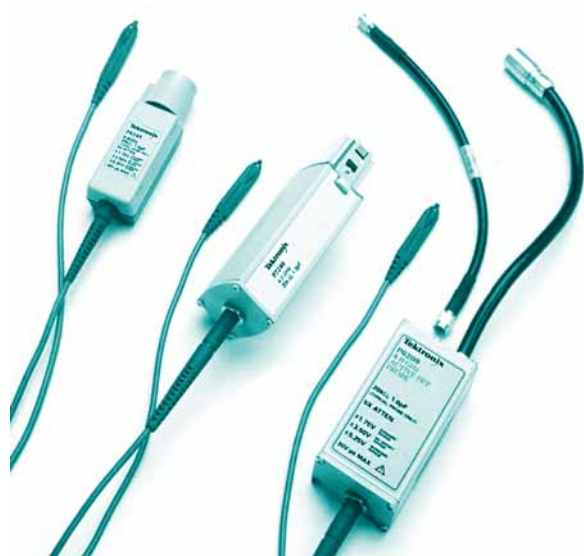
Obr. 11 - Aktivní sondy, zleva P6249 s rozhraním TEKPROBE II (TDS7054 a TDS7104), P7240 s rozhraním TEKCONNECT (TDS7404) a P6209 (TDS8000, CSA8000 – vzorkovací přístroje do 50 GHz)
