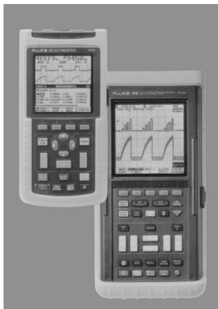
Obr. 20 - Kapesní DPO Fluke. Vlevo Scopemeter 123 ( B_0 = 20 MHz opakované jevy i jednorázově, f_v = 1,25 GS/s). Vpravo Scopemeter 99B ( B_0 = 100 MHz opakované jevy i jednorázově, f_v = 1,25 GS/s). Přístroje jsou dvoukanalové a fungují i jako digitální multimetry, měří skutečnou efektivní hodnotu (true RMS).
