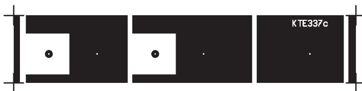
Obr. 1 až 3 - Pásek plošných spojů pro upevnění vstupních konektorů BNC z jednostranného kuprextitu tloušťky 1 mm; vlevo je umístěn pro srovnání ilustrační snímek celé sestavy; dole pak pohled na čelní panel
